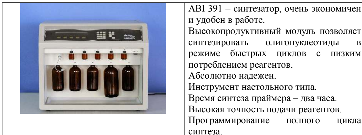
Рисунок 14 – Высокопроизводительная модель ABI model 391 фирмы Applied Biosystems (США)
